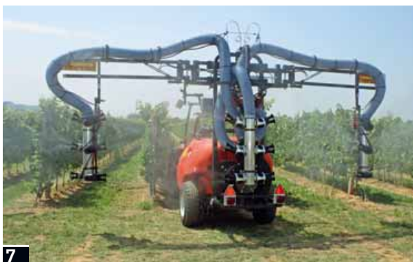
Foto 6-7 Esempi di sistemi a getto mirato a torretta (6) e con testata multifila scavallatrice (7)
