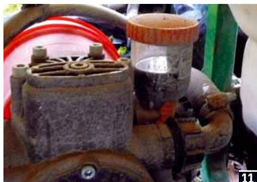
Foto 11-12 Durante la manutenzione è fondamentale controllare il corretto funzionamento del livello dell'olio (foto 11) e del manometro (foto 12)
