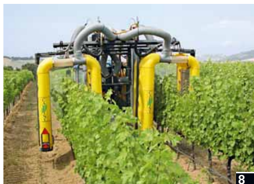
Foto 8-9 Irroratrice a tunnel (8) e a carica elettrostatica (9)
