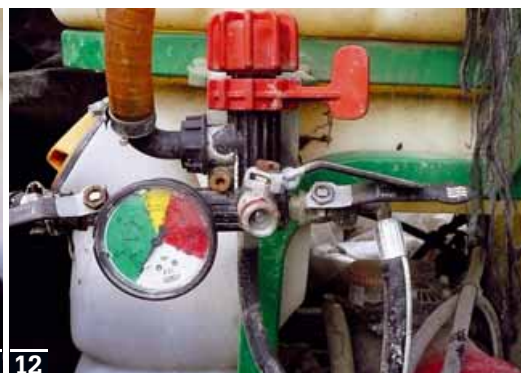
Foto 11-12 Durante la manutenzione è fondamentale controllare il corretto funzionamento del livello dell'olio (foto 11) e del manometro (foto 12)
